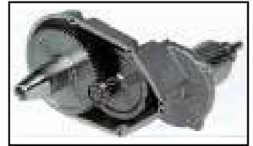
El total recubrimiento del motor con una carcasa plástica y hermética, y la unión del motor con el reductor por mediación de un engranaje especial en plástico de alta resistencia, hacen que el moto-reductor tenga un DOBLE AISLAMIENTO TÉRMICO, garantizando por completo la integridad física del operario, y protegiendo a su vez de una forma absoluta todos los componentes eléctricos de la máquina.
