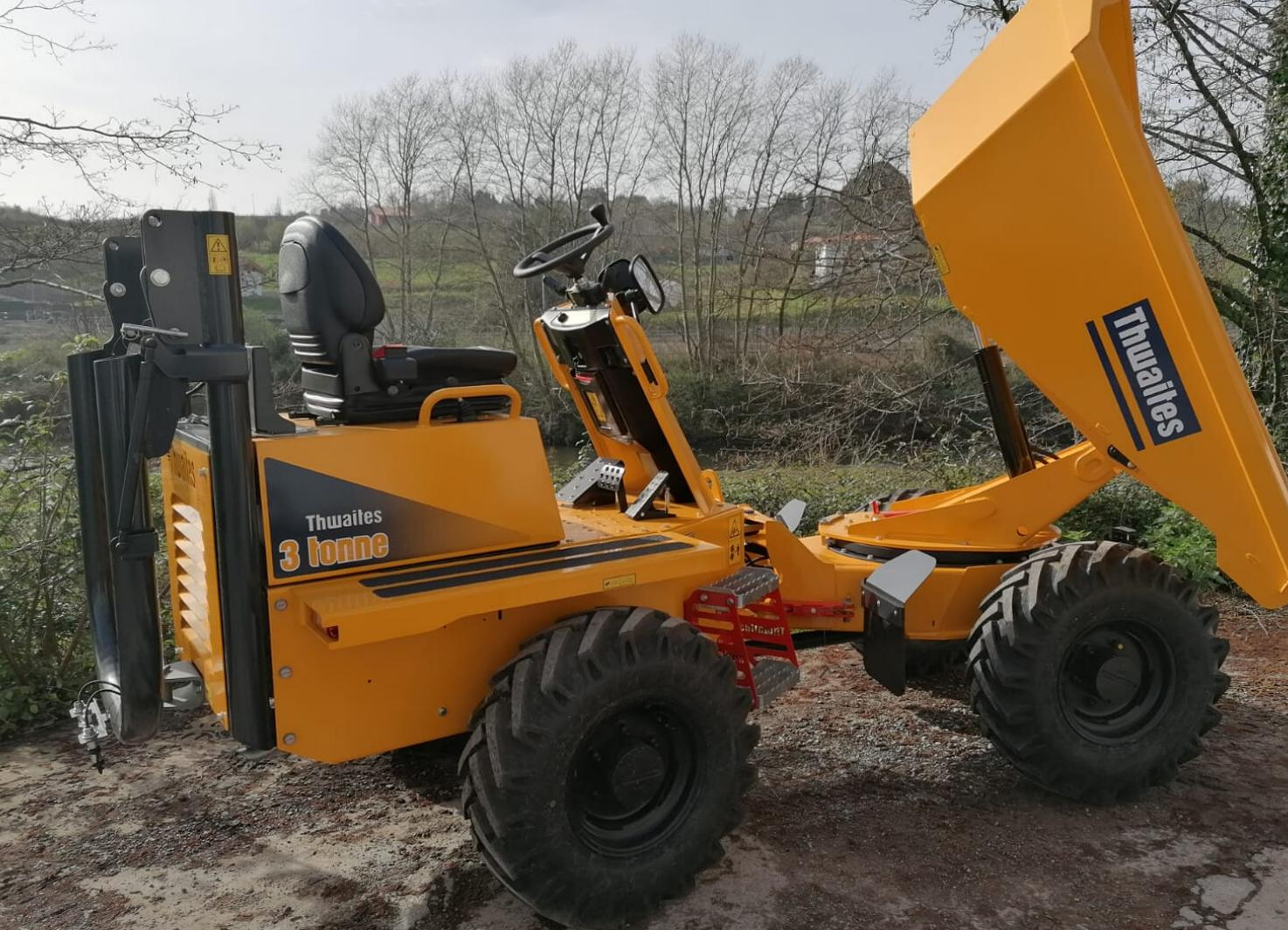
El motor Yanmar (Stage V, sin DPF) de tres cilindros, junto con una transmisión hidrostática y los ejes Dana, otorgan a este dumper una incomparable fiabilidad, rendimiento y capacidad todoterreno, lo que genera una productividad excepcional.
