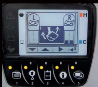
Ajuste del caudal de aceite máximo (circuitos aux. 1 y 2)
